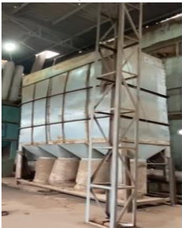
HTXLKT công đoạn sàng thô (xưởng sản xuất ván PB)
