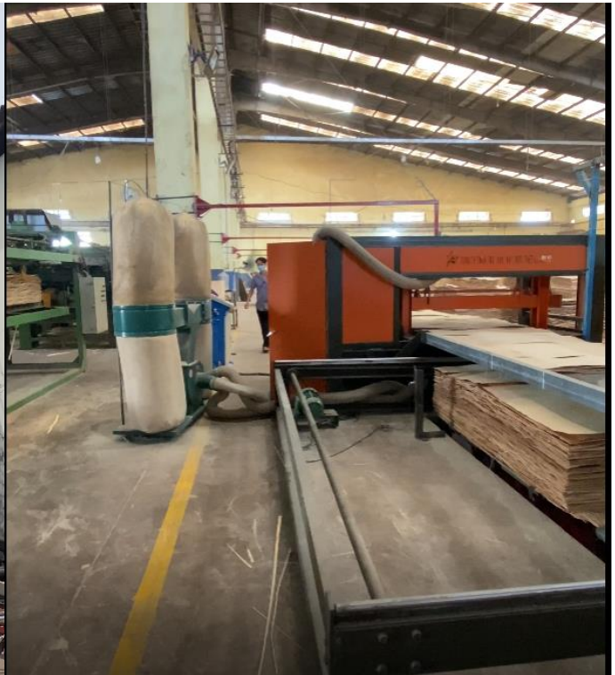
HTXLKT di động tại công đoạn cắt (xưởng sản xuất ván Plywood)
