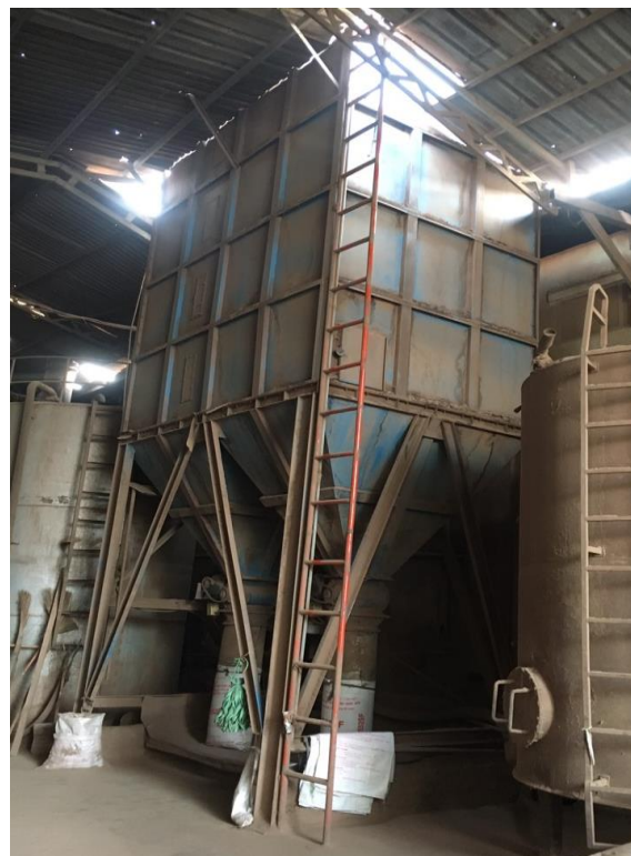
HTXLKT tại công đoạn sàng tinh và nghiền (xưởng sản xuất ván PB)
