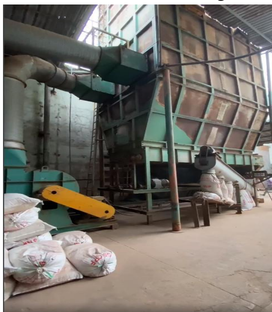
HTXLKT tại công đoạn sàng tinh và trải thảm (xưởng sản xuất ván PB)
